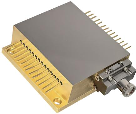
R7M是杏林睿光半导体AW系列多功能激光模组，多波长输出，可集成3-4种不同波长的主激光。光纤插拔式设计，配置光纤开关、PD光电探测器、RT热敏电阻、可更换防尘窗口片等功能。
