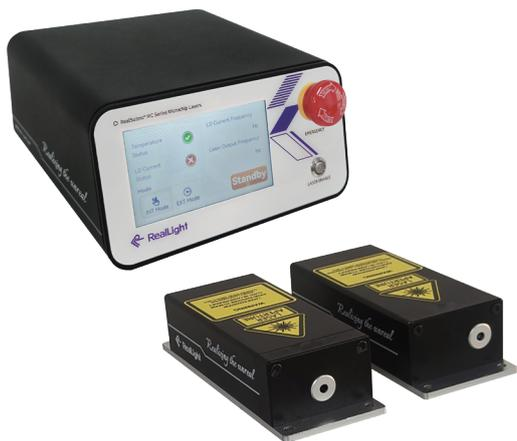
MCI系列微片激光器产品是基于半导体泵浦的被动调Q固体激光器，包含946nm、473nm两种波长。该系列产品采用半导体泵浦模块和激光晶体一体化设计，激光头小巧紧凑，方便安装，支持内、外触发，单脉冲能量稳定，光束质量好。优越的产品性能指标使得它在雷达测距、光谱检测市场有着广泛应用。
