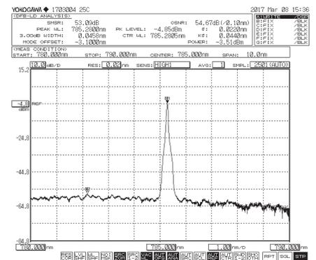
785nm激光光谱图（边模抑制比 $>40\text{dB}$ ）
